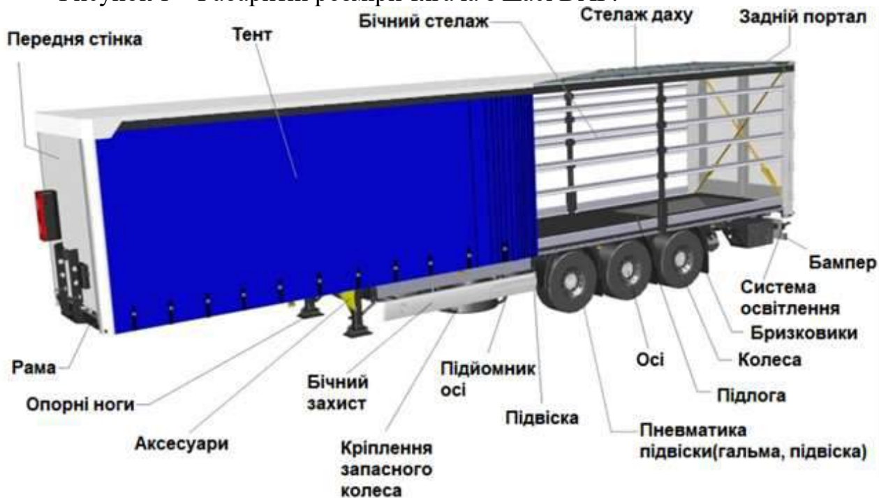
Рисунок 2. – Будова тентового напівпричепи Schmitz Cargobull SCS
