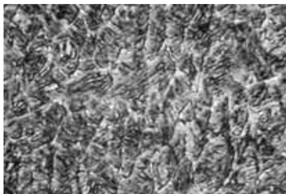
Рисунок 1 – Мікроструктура нарощеного на поверхню шару
