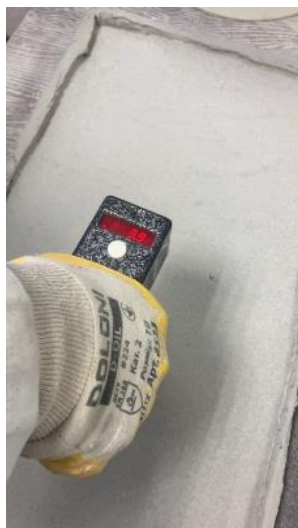
Рис. 1. Визначення міцності у віці 7 діб затверділого розчину неруйнівним методом
