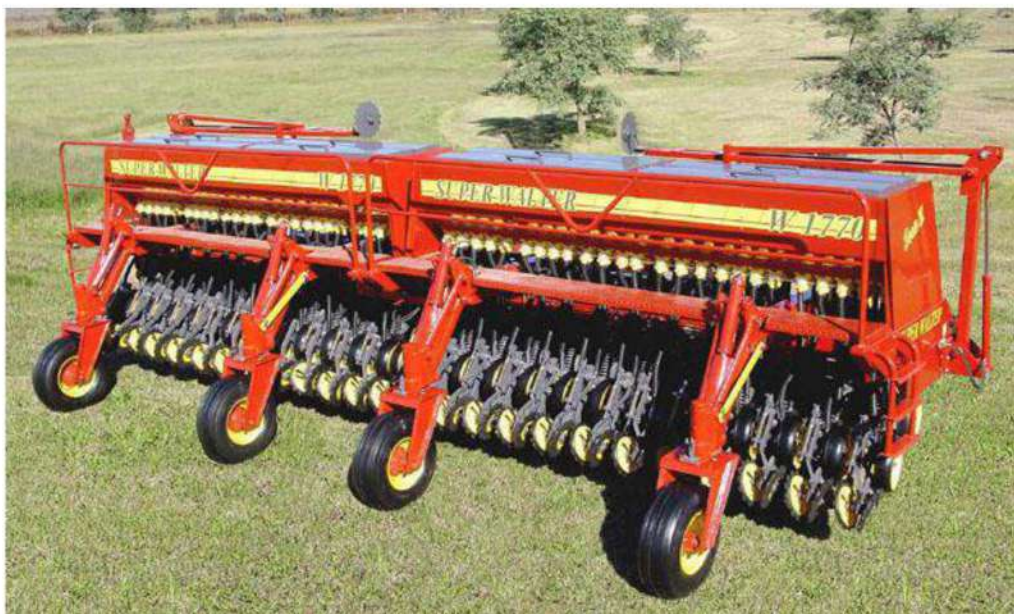
Рисунок 2. Загальний вигляд сівалки Super Walter, що використовується для посіву зернових культур за технологією NO-TILL
