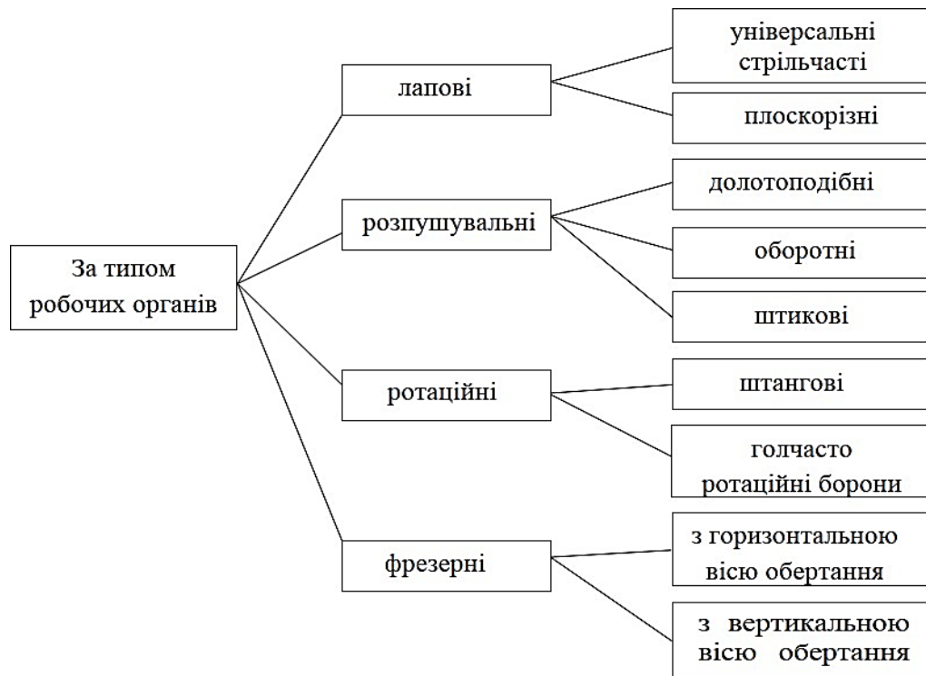
Рисунок 1 – Класифікація культиваторів для суцільного обробітку ґрунту
