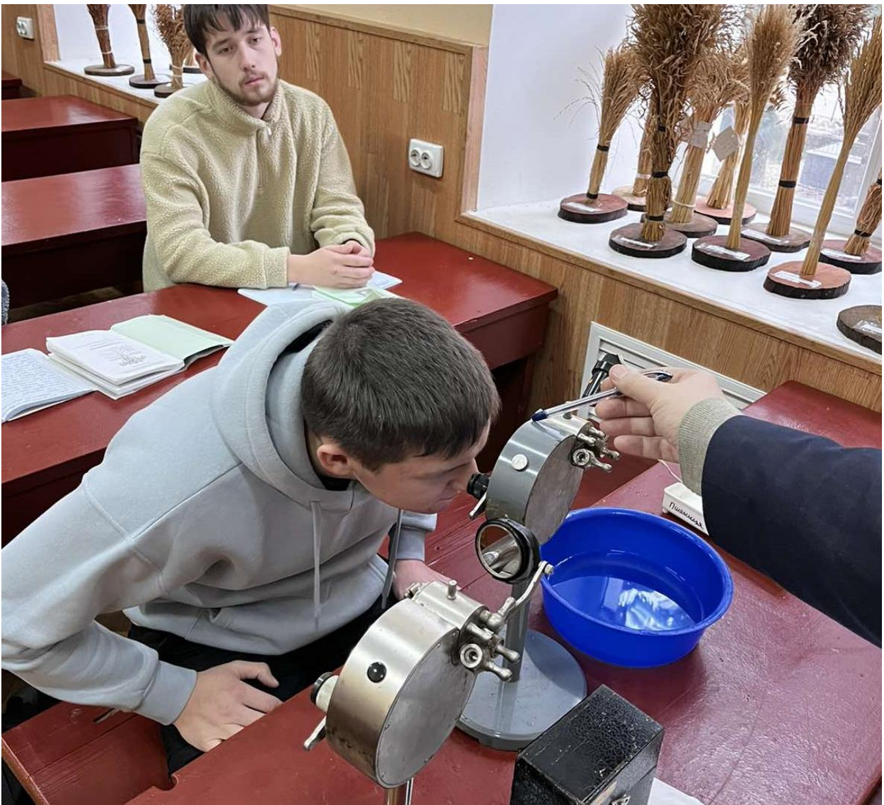
Здобувачі вищої освіти визначають вміст розчинних сухих речовин за допомогою лабораторного рефрактометра РПЛ-3.
