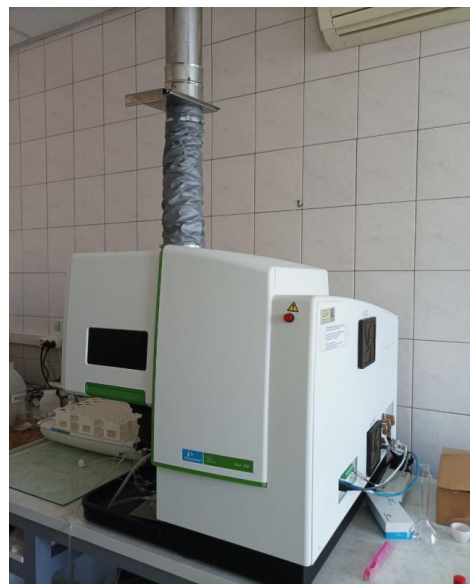
Рисунок 2 - Оптико-емісійний спектрометр з індуктивно-зв'язаною плазмою Avio 200
