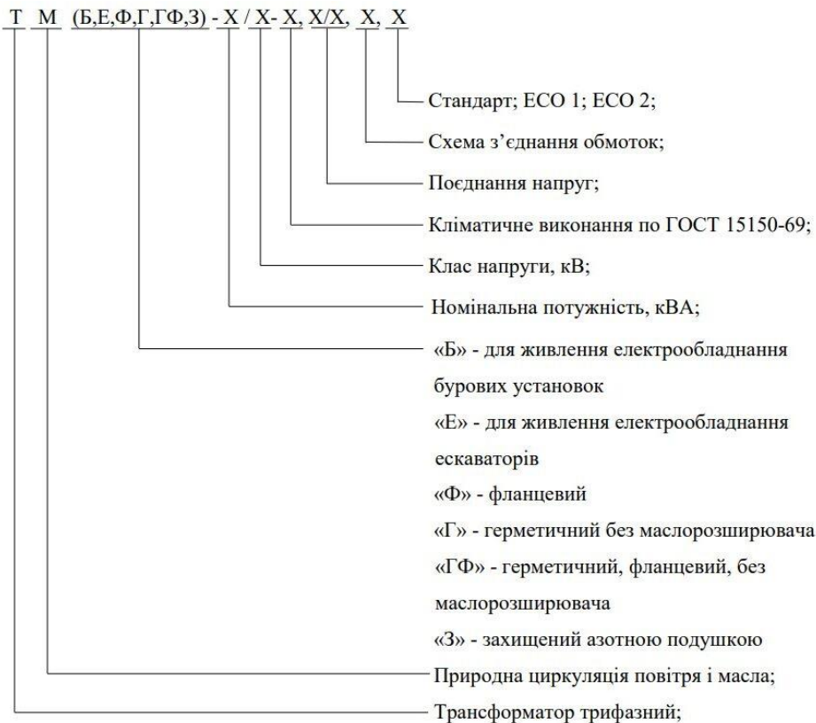
Рисунок 1. Структура умовного позначення типу трансформатора.
