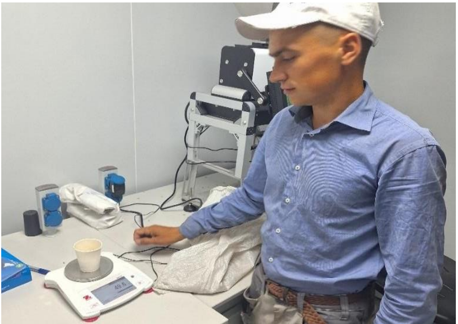
Визначення маси 1000 насінин на машині Data Count та за допомогою лабораторних вагів.
