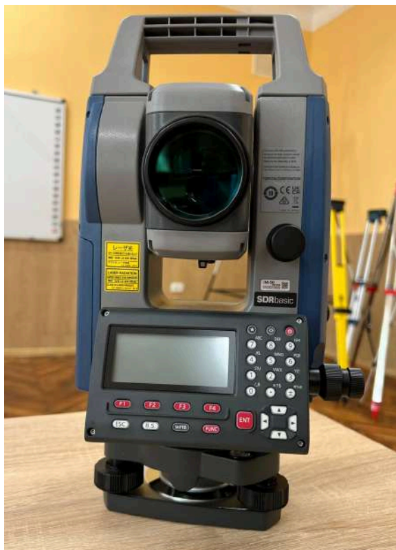
Електронний тахеометр SOKKIA iM-55 здатен вимірювати відстані в режимі без відбивача до 500 метрів з точністю 2.0мм + 2ppm, в режимі на одну призму до 4000 метрів з точністю 1.5мм + 2ppm. Швидкість вимірювання в точному режимі становить лише 0.9 секунди, а в швидкому 0.6 секунди. Вбудоване програмне забезпечення і неабиякі технічні можливості роблять тахеометри серії iM незамінними помічниками в будівництві, маркшейдерській справі, землеустрої, топографії, під час проведення вишукувань тощо.
