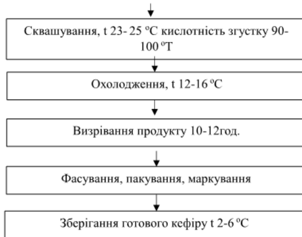
Рисунок 1.2.3. - Технологічна схема виробництва кефіру нежирного
