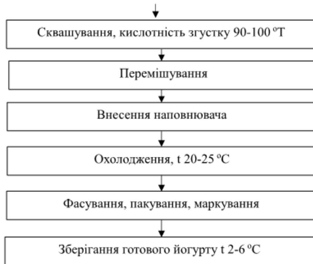
Рисунок 1.2.2 - Технологічна схема виробництва йогурту з масовою часткою жиру 2.5%
